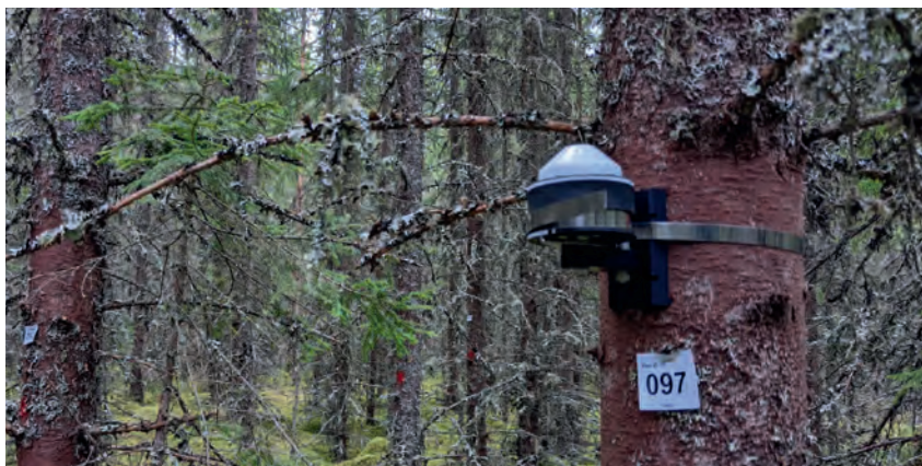
Dette såkalte bånd-dendrometeret er granas pulsklokke. Det gjør løpende målinger og kan registrere selv mikroskopiske endringer av diameteren.
